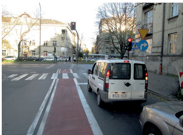
Fot. 41. Skrzyżowanie ul. Dunin-Wąsowicza z al. Krasińskiego (dwujezdniowa, z pasem dzielącym). Pas filtrujący doprowadza rowerzystów do drogi dla rowerów na wprost i ul. Smoleńsk w głębi. Rozwiązanie zapewnia brak kolizji ze strumieniem pojazdów skręcających w prawo (obowiązuje nakaz skrętu w prawo z wyłączeniem rowerzystów) i umożliwia optymalne wykorzystanie przepustowości sygnalizacji.
