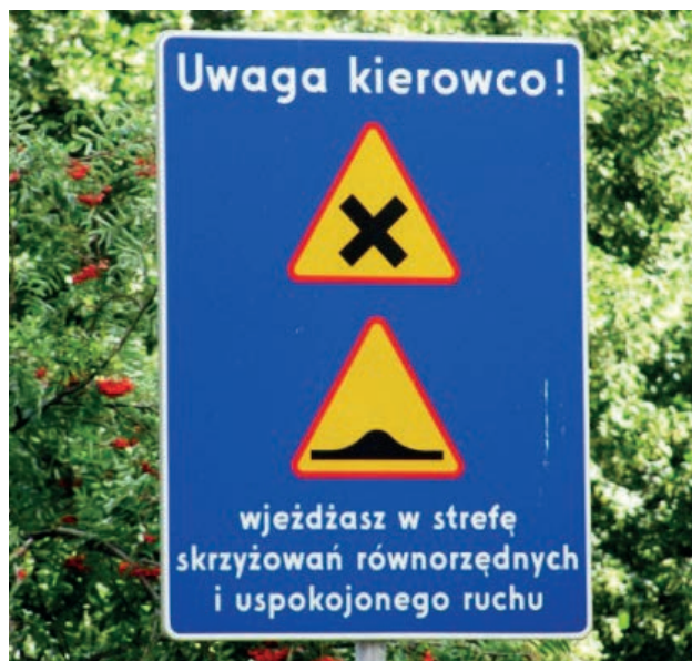
Fot. 7. Wydzielenie strefy Tempo 30 powoduje, że można znacząco ograniczyć liczbę znaków drogowych, ograniczając się do znaków na wjazdach do strefy.
