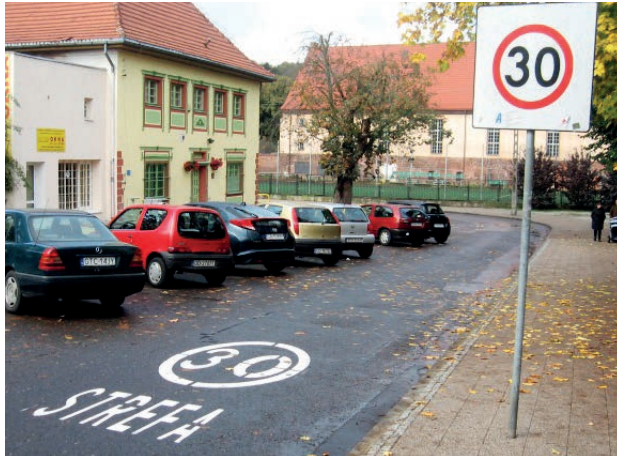
Fot. 5. Oznakowanie wjazdu do strefy powinno zostać podkreślone czymś więcej niż znakiem pionowym. Dobrym pomysłem jest uzupełnienie go oznakowaniem poziomym, tak jak na ulicy Kanapariusza.
