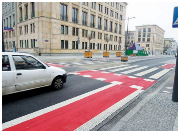
Fot. 20. Przejście przez jezdnię z pasami ruchu o szerokości 3 m i pasem dzielącym pełniącym funkcję azylu.
