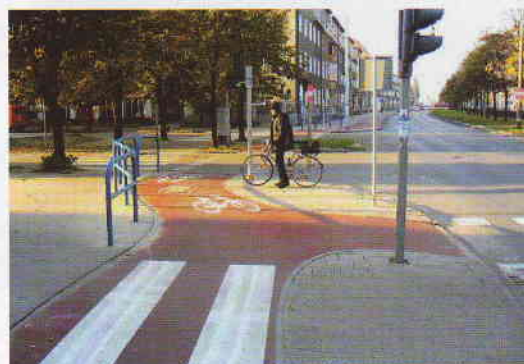
Prawidłowe rozwiązanie skrzyżowania z przestrzenią akumulacji, tak by rowerzyści oczekujący na skręt nie blokowali drogi jadącym prosto. Barierki zapobiegają skracaniu drogi po ścieżce przez pieszych, mogą też służyć do zaparkowania roweru.
