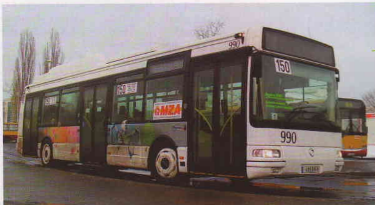
Autobus napędzany sprężonym gazem ziemnym Irisbus Agora GNV, testowany na warszawskiej linii autobusowej 150 Mariensztat – Szczęśliwiec (PD)
