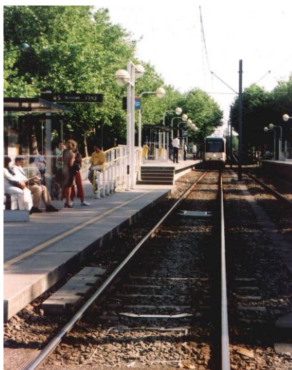
Amsterdam: podwójne przystanki tramwajowe różnej wysokości, gdyż część tramwajów wjeżdża do tunelu metra. (KR)
