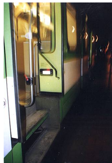
Hanower: tramwaje posiadają stopnie opuszczane na niskich przystankach poza tunelem. (KR)
